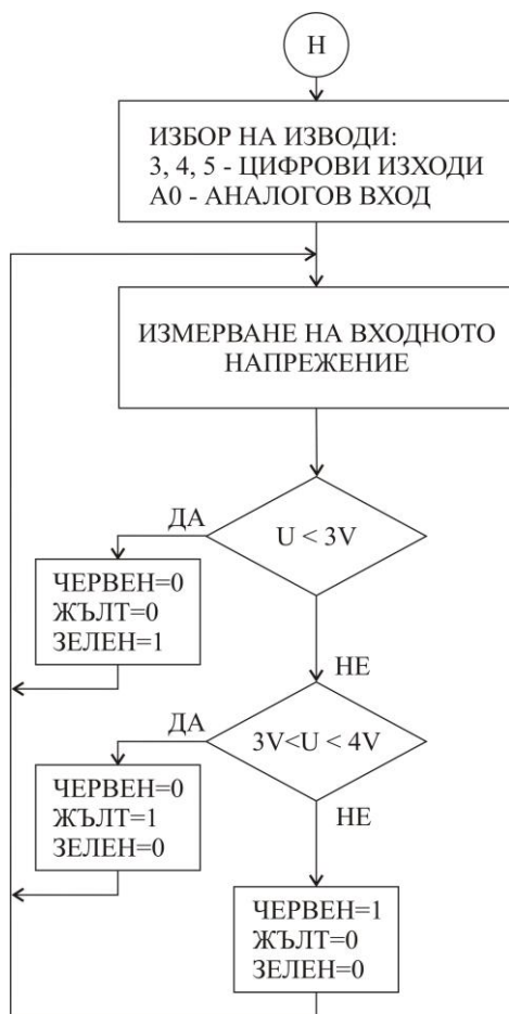
Фиг. 3.5. Алгоритъм за управление на сигнализация според стойността на входното напрежение
